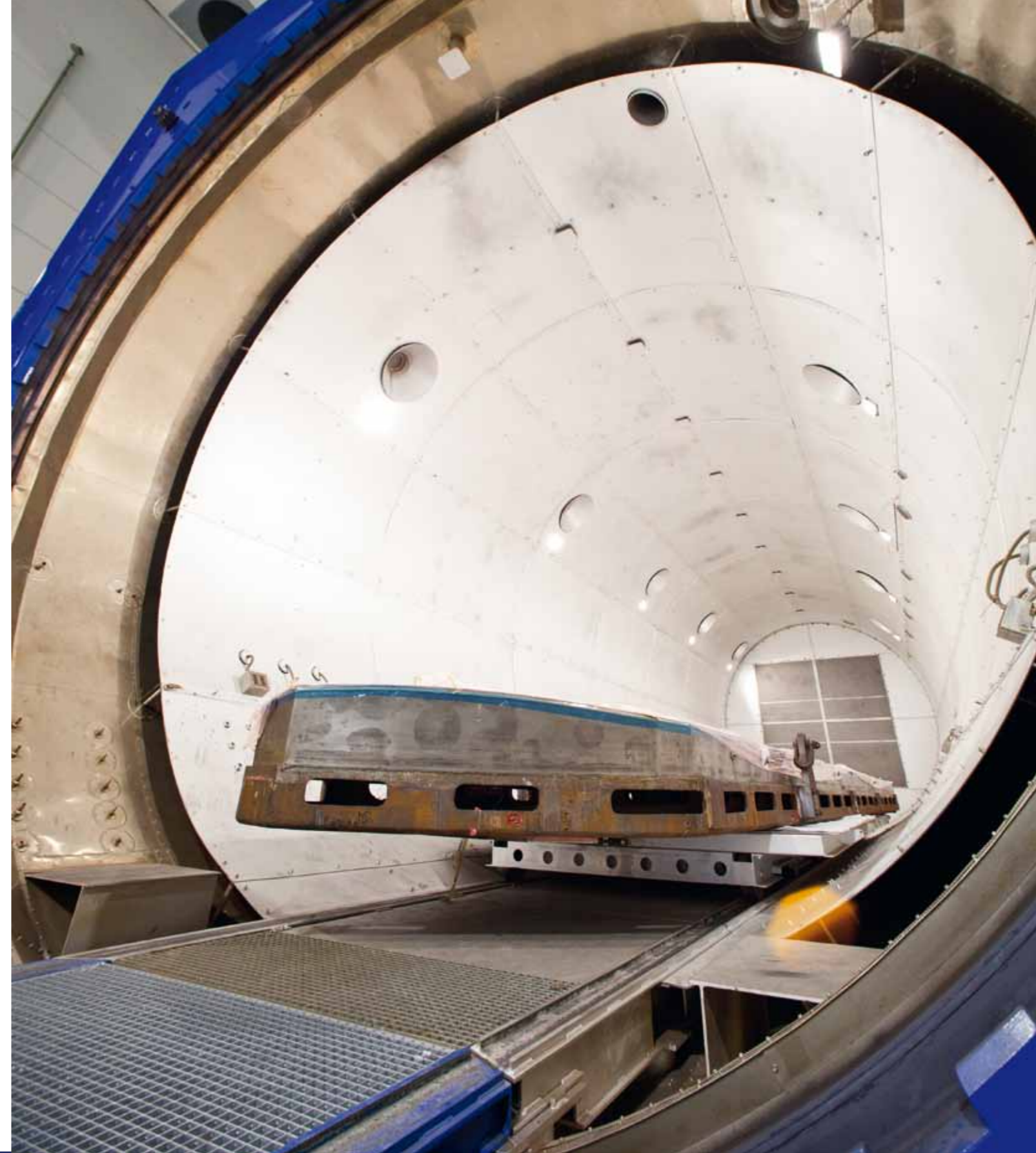
Najveći autoklav na svijetu za istraživanje može primiti dijelove dužine do 20 m
