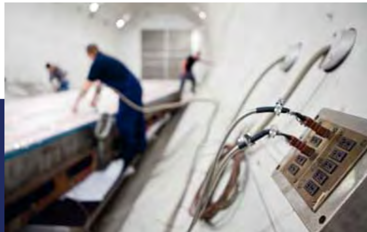
DLR znanstvenici „kabliraju“ izradak u autoklavu u svrhu mjerenja
