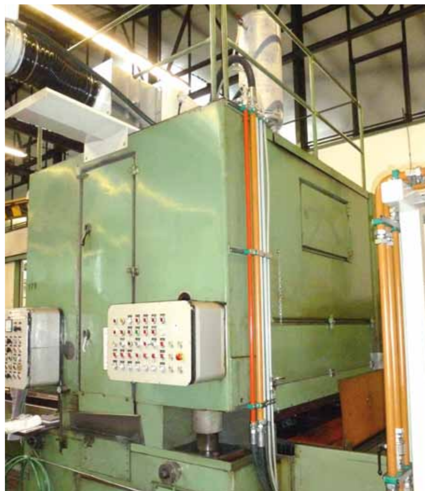
U radnoj hali instalirana podugovorna stanica isporučuje komprimirani zrak između ostaloga za brusne centre, koji imaju spremnike za komprimirani zrak (desno)
