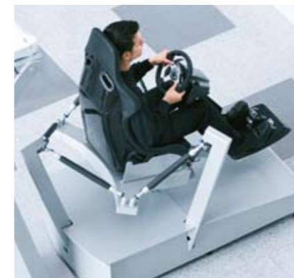
Pneumatski mišić tvrtke Festo, jedne od najnaprednijih bioničkih aplikacija na osnovi komprimiranog zraka, ima ogroman raspon primjene; fascinantne video snimke te tehnike možete naći na web stranici tvrtke Festo: [www.festo.com](http://www.festo.com)
