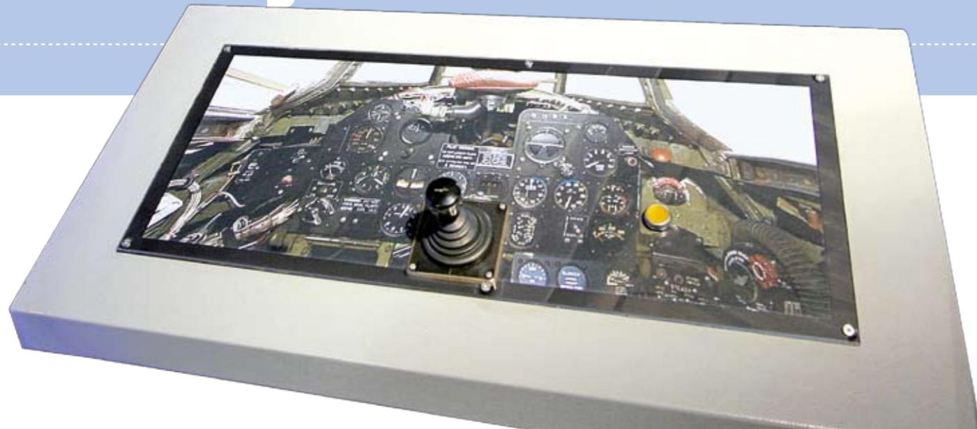
skom i električnom pogonskom tehnikom. Kretnje upravljačke ručice se pomoću "pneumatskih mišića" koje je razvila tvrtka Festo prenose na zrakoplov. Ti bionički univerzalni geniji postižu destrostruku snagu tlačnih cilindara usporedivih dimenzija. Vrlo su robusni i mogu djelovati pod ekstremnim uvjetima, pri-
